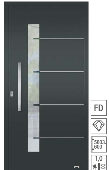
5341 Stoßgriff auf Füllung montiert, vorne: VSG mattiert mit klaren Streifen, hinten: Float beschichtet, Lisenen in NIRO-Design nicht flächenbündig, Oberfläche: ca. RAL 9005 Deep Black FS
