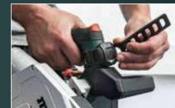
**3.** Netzsauger auf »manuell« drehen oder einschalten. Akku-Maschine starten. Sauger wird automatisch durch die Wahrnehmung von Vibrationen ein-/ausgeschaltet.
