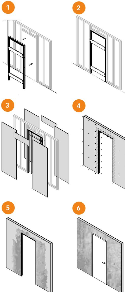
Da die Piur-U-Design-Zarge zwischen den Leibungen befestigt wird, sollten bereits in der Planungsphase die Rohbauöffnungen um ein Rastermaß breiter und höher (+ 125 mm) geplant werden, um eine optimale Durchgangsbreite bzw. -höhe zu erhalten. Eine maximale Höhe bis 2700 mm (Wandöffnungshöhe) kann angeboten werden. Wir empfehlen, die Piur-U-Design-Zarge zeitgleich mit der Leichtbauwand zu montieren, ein eventuelles Anputzen sollte mit faserverstärktem Putz und Gewebeband erfolgen.
