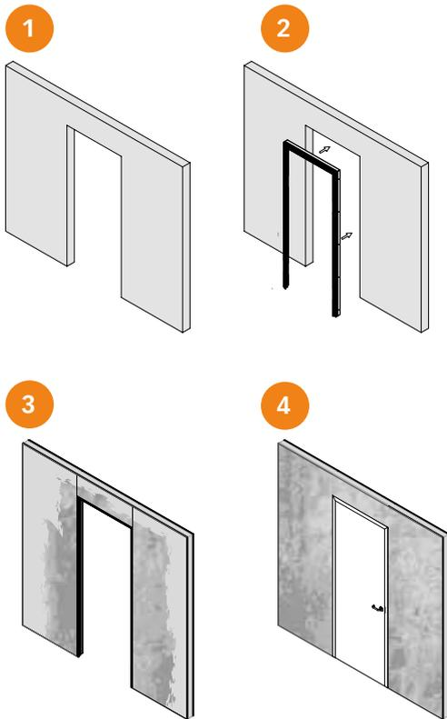
Da der PIUR-B-Design Blockrahmen zwischen den Leibungen befestigt wird, sollten bereits in der Planungsphase die Rohbauöffnungen um ein Rastermaße breiter und höher (+125 mm) geplant werden, um eine optimale Durchgangsbreite bzw. -höhe zu erhalten. Eine maximale Höhe bis 2755 mm Wandöffnungshöhe kann angeboten werden.
