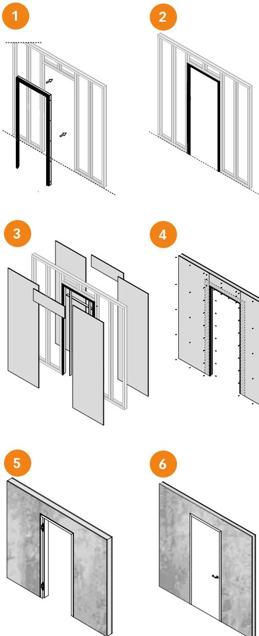
Da der Montageblock zwischen den Leibungen befestigt wird, sollten bereits in der Planungsphase die Rohbauöffnungen um ein Rastermaß breiter und höher (+ 125 mm) geplant werden. Durch den im Montageblock integrierten Alu-Winkel wird das saubere Anputzen gewährleistet. Wir empfehlen, den Montageblock zeitgleich mit der Leichtbauwand zu montieren, ein eventuelles Anputzen sollte mit faserverstärktem Putz und Gewebekband erfolgen.
