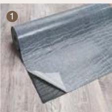
Die Towilan Unterlage ist eine Renovierunterlage für Designbodenbeläge. Die hohe Druckstabilität ermöglicht ein überbrücken von Rissen und Fugen mit einer Breite von bis zu 8 mm. Die TowiLan Unterlage ist nivellierend und dimensionsstabil. Trittschalldämmung 17 dB
